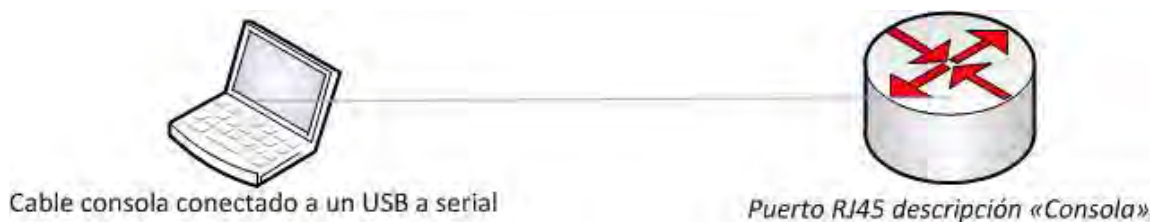
Figura 2 Conexión Física al Router
