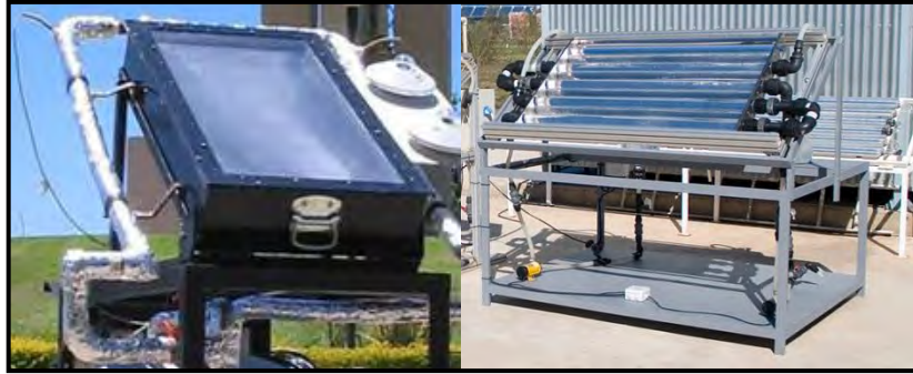
Figura 9. Colectores solares sin concentración. Izquierda, Reactor de placa plana; derecha, foto-reactor tubular.
