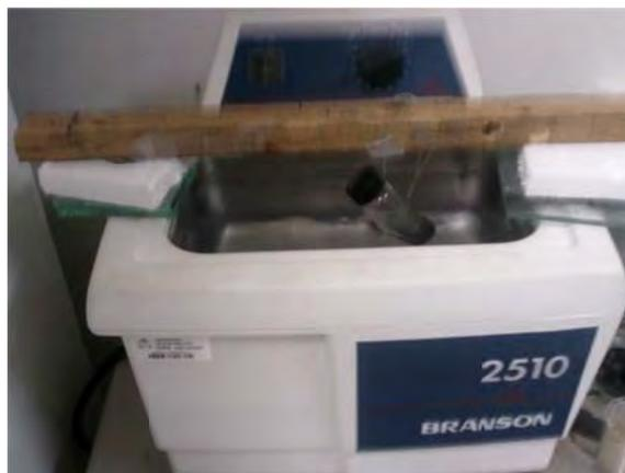
**Figura 3.3** Baño ultrasónico utilizado para la dispersión de NTC`s en el disolvente.
