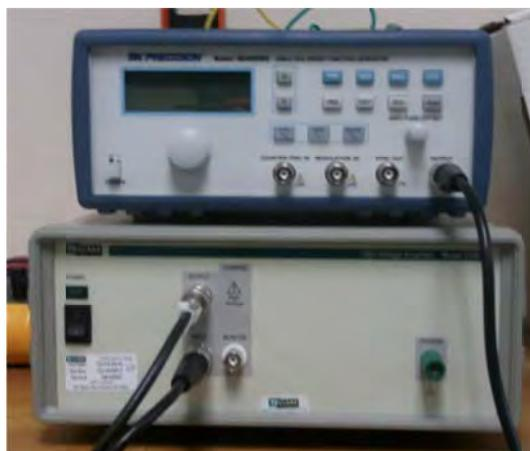
**Figura 3.5** Equipo para aplicación de campo eléctrico.
