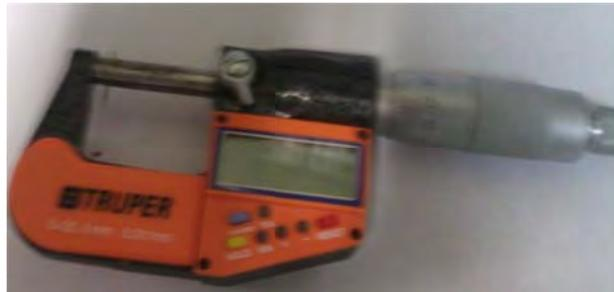
**Figura 3.8** Micrómetro utilizado para conocer el espesor de cada probeta.
