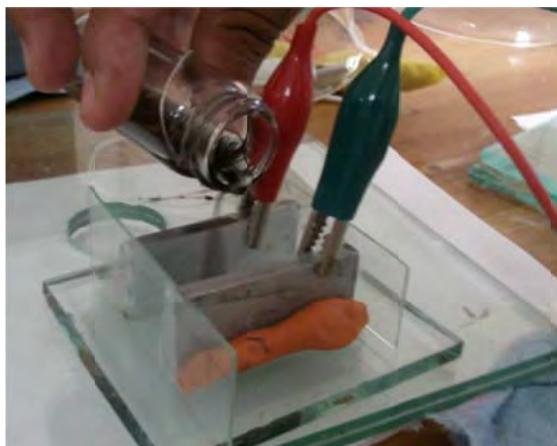
**Figura 3.4 Vertido de la solución PSF-CH<sub>3</sub>Cl-CNT en la celda diseñada, previamente a la influencia del campo eléctrico.**
