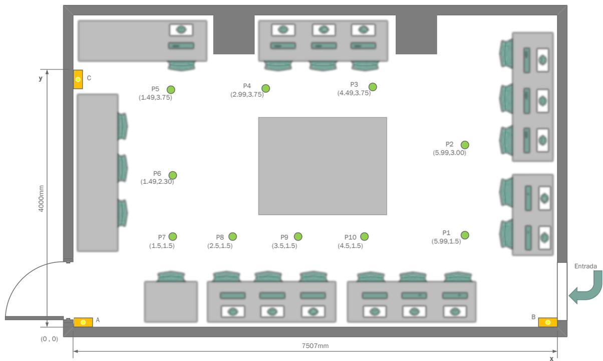
Figura 20 Escenario de medición B: Estimación de coordenadas (x, y)
