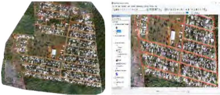
Figura 2. Ortomosaico del asentamiento humano Fraternidad Antorchista. Fuente. Elaboración propia. Generado con la herramienta informática Pix4D-Mapper .
