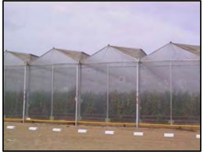
Figura 13. Techo conocido como "dos aguas" para la recolección de agua de lluvia.
