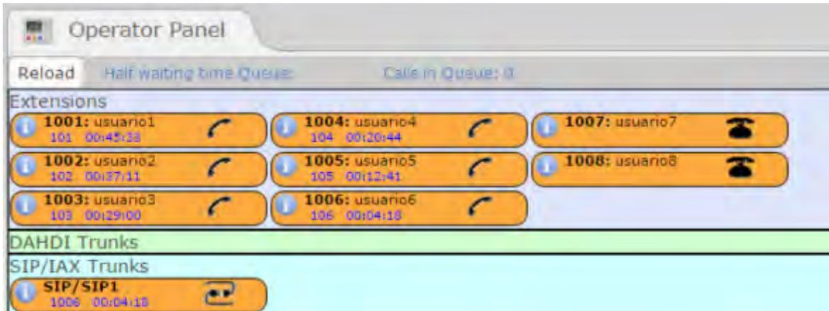
Figura 4-14. Extensiones del servidor SIP1 llamando a las extensiones del servidor SIP2.
