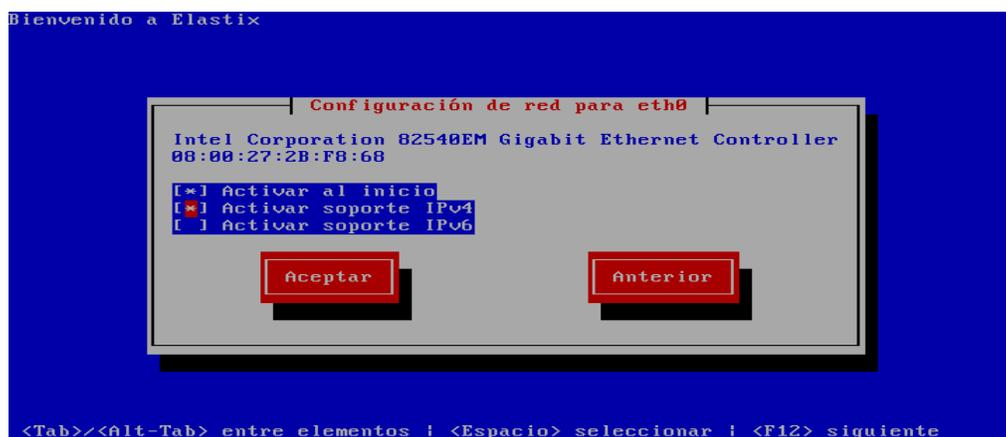
Figura A-8.- Configuración de red para la interfaz eth0.
