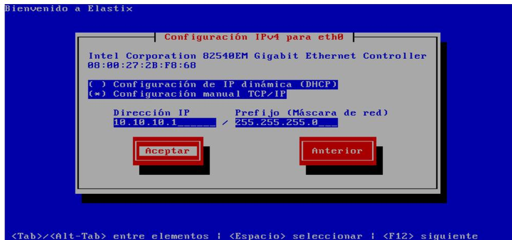
Figura A-9 Configuración IPv4 para eth0.
