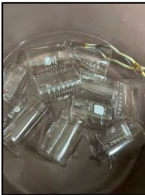
Figura 5. Limpieza de materiales con ácido clorhídrico al 20%.
