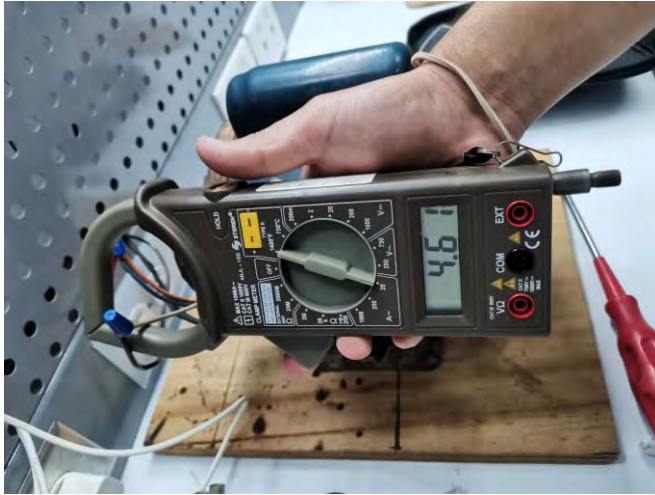
Figura 98 Medición de corriente con amperímetro de gancho y comparando la medición del PLC en la pantalla HMI.
