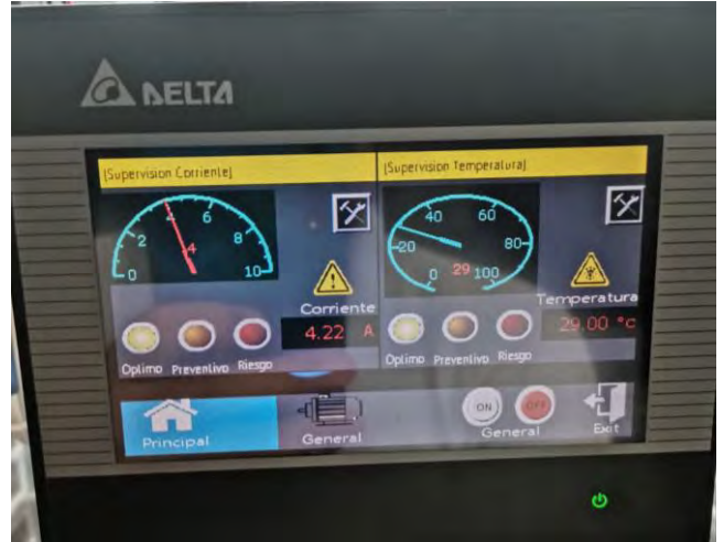
Figura 98 Medición de corriente con amperímetro de gancho y comparando la medición del PLC en la pantalla HMI.
