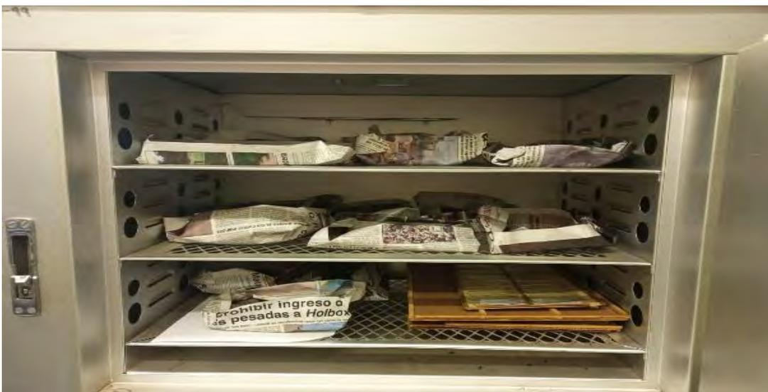
Figura 11. Introducción de las muestras de suelo a la estufa para el secado. Fotografía: Valdez, L.
