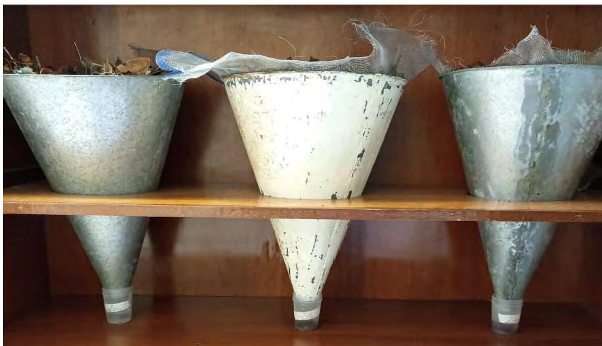
Figura 9. Método embudo de Berlesse-Tullgren (Palacios-Vargas et al.,2007) para la obtención de los microartrópodos edáficos. Fotografía: Valdez, L.
