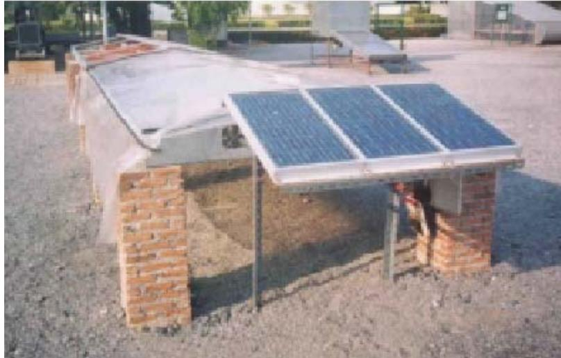
Figura 1.7. Secador solar tipo túnel con páneles fotovoltaicos.
