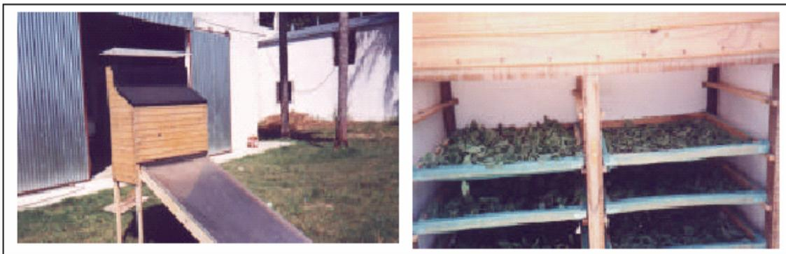
Figura 1.3. Secador tipo gabinete y detalle del interior de la cámara de secado.
