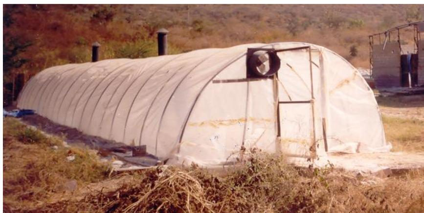
*Figura 1.6. Secador solar tipo túnel.*
