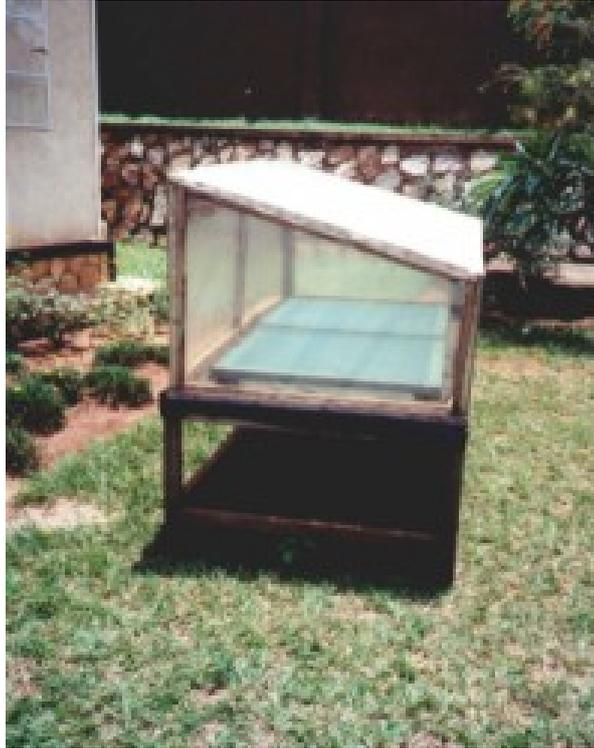
*Figura 1.1. Fotografía de un secador solar directo.*
