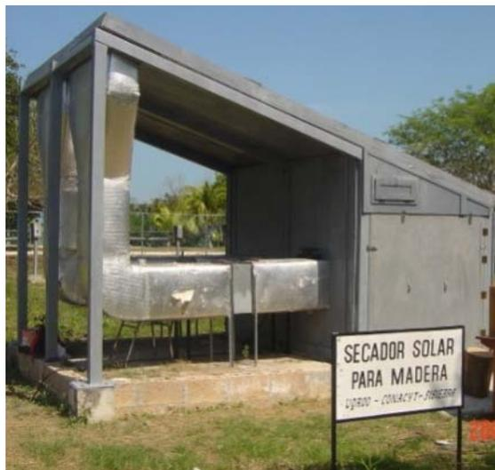
Figura 3.5. Secador solar tipo indirecto.
