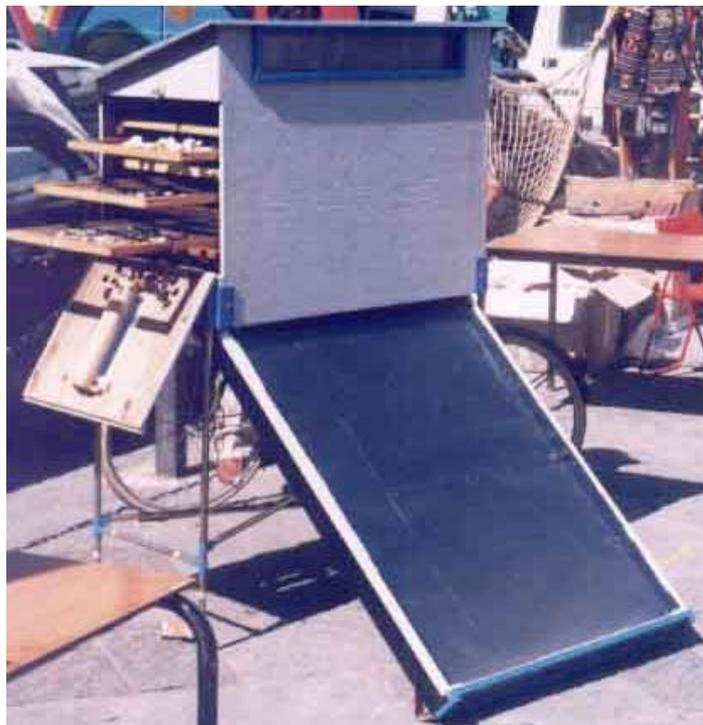
*Figura 1.2. Fotografía de un Secador solar indirecto.*
