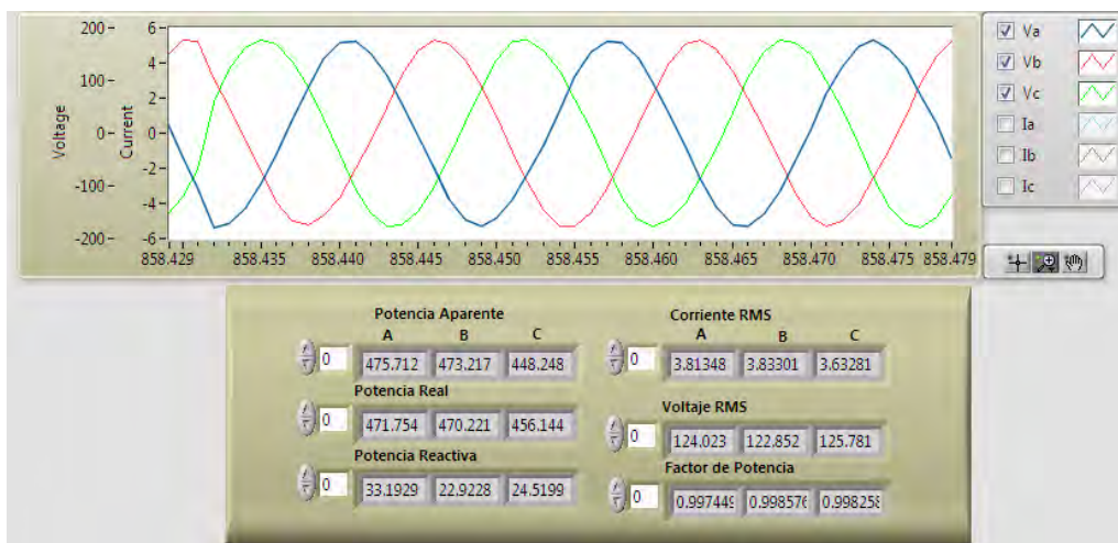
Figura 4.1. Mediciones de tensión en carga resistiva, sbRIO.
