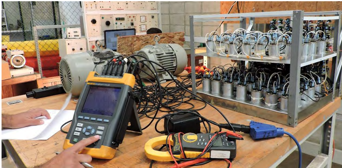
Figura 3.19. Implementación del sistema de medición con el generador de inducción
