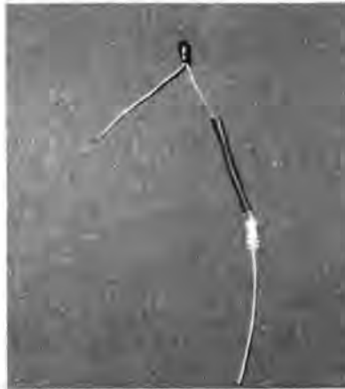
Figura 3.3: Termistor Soldado a una Resistencia de 2.2 K \Omega
