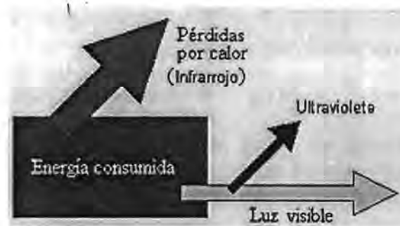
Figura. 7.- Balance energético de una lámpara de descarga.
