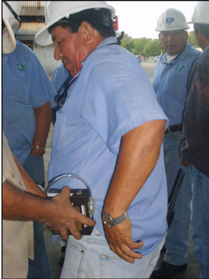
**Fotografía 6.** Muestreo con bomba de aire personal en el área de Batey
