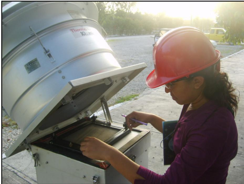
**Fotografía 7.** Muestreo en la colonia de empleados de Ingenio San Rafael de Pucté con el medidor “Altos Volúmenes”.
