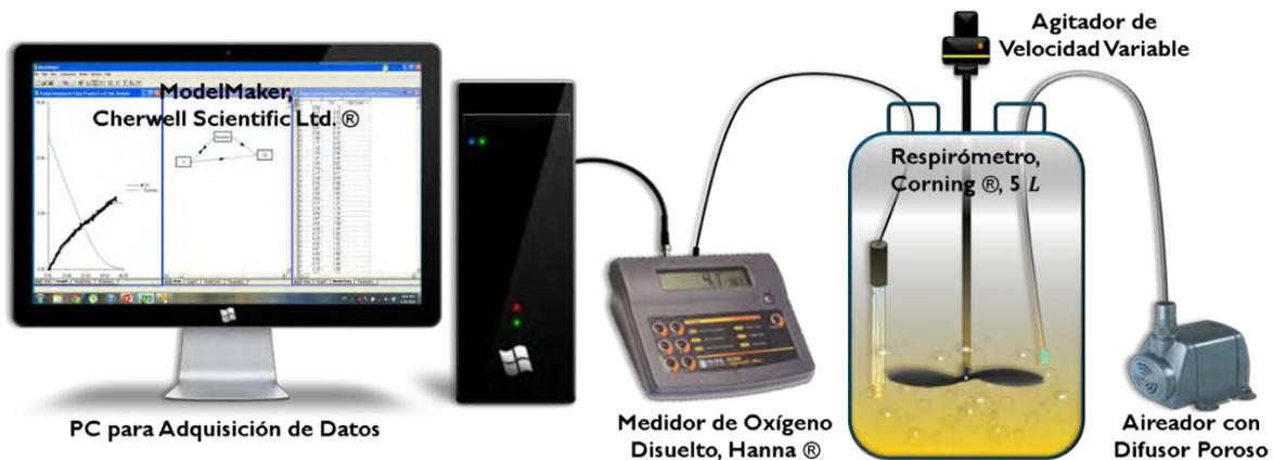
Figura 2-1. Ilustración del arreglo experimental del método respirométrico Extant.
