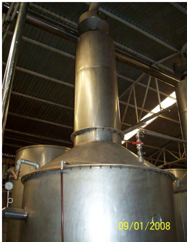
Fig. 1.12 Foto de alambique en el cual se evapora el fermento.
