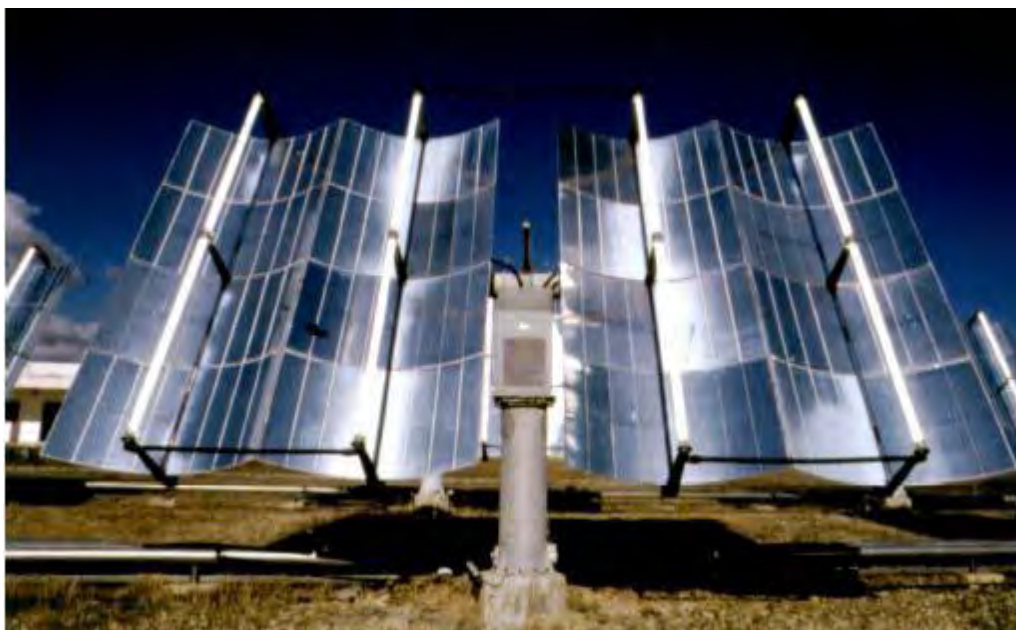
Fig. 4.3 Concentrador cilindro-parabólico Helioman con seguimiento en dos ejes para aplicaciones de fotocatalisis (PSA-CIEMAT).
