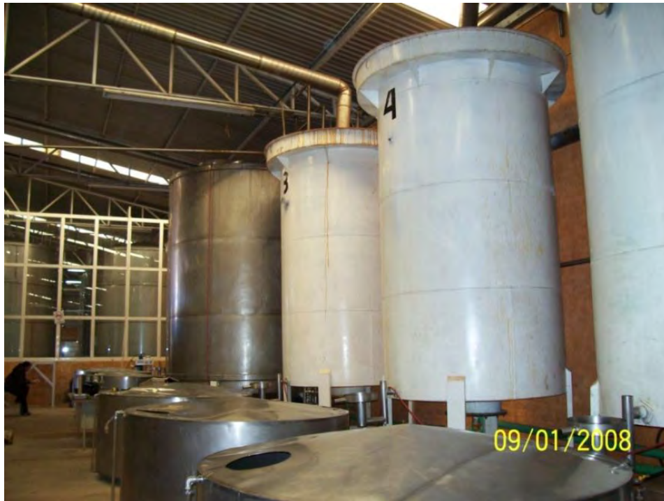
Fig. 1.13 Foto de condensadores que reciben los vapores de los alambiques.
