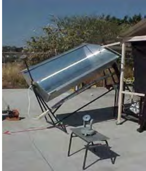
Fig. 4.4 DICEF con seguimiento, instalado en la plataforma de concentración solar (CIE-UNAM).
