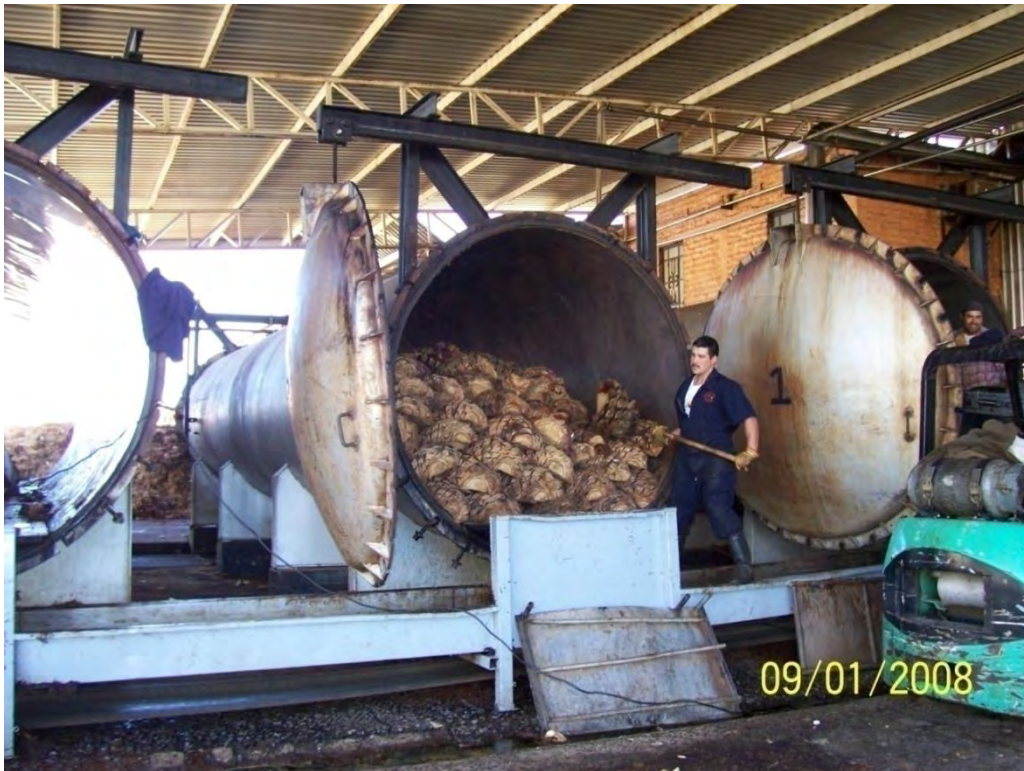
Fig. 1.4 Foto de un autoclave durante el llenado.
