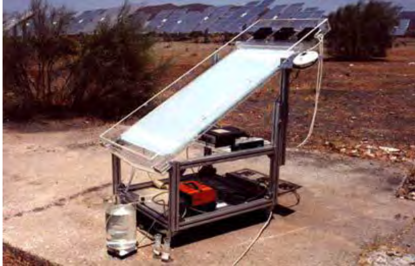
Fig. 4.1 Instalación experimental de un sistema de placa plana (PSA).
